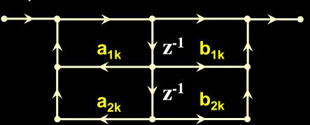
$$H_{k}(z) = \frac{1 + b_{1k}z^{-1} + b_{2k}z^{-2}}{1 - a_{1k}z^{-1} - a_{2k}z^{-2}}$$
