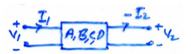
$$\begin{bmatrix} V_1 \\ I_1 \end{bmatrix} = \begin{bmatrix} A & B \\ C & D \end{bmatrix} \begin{bmatrix} V_2 \\ -I_2 \end{bmatrix}$$
