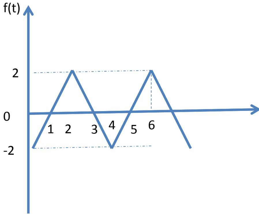
$$f(t) = (2t-2) \cdot [U(t) - U(t-2)] + (-2t+6) \cdot [U(t-2) - U(t-4)] + (2t-10) \cdot [U(t-4) - U(t-6)] \dots$$
