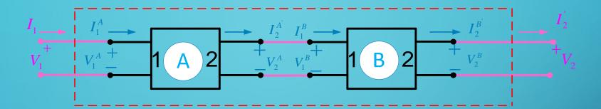
$$\begin{bmatrix} V_{1} \\ I_{1} \end{bmatrix} = \begin{bmatrix} V_{1}^{A} \\ I_{1}^{A} \end{bmatrix} = \begin{bmatrix} ABCD^{A} \end{bmatrix} \begin{bmatrix} V_{2}^{A} \\ I_{2}^{A} \end{bmatrix}$$
